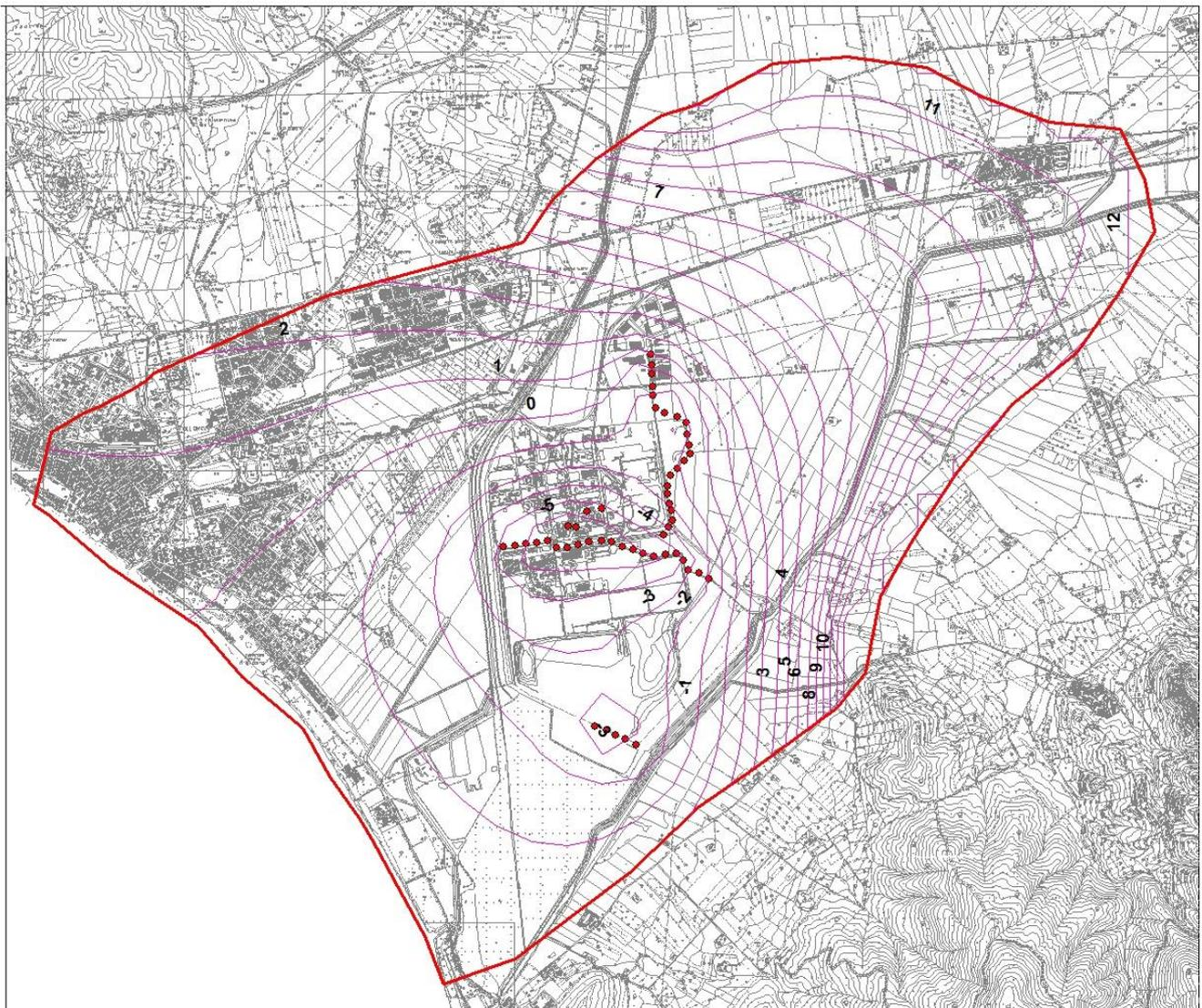
Figura 60. Ricostruzione dell'andamento di falda in condizioni di progetto (barrieramento attivo – 10° anno): è chiaramente visibile l'effetto dovuto al nuovo sistema di barrieramento idraulico.
