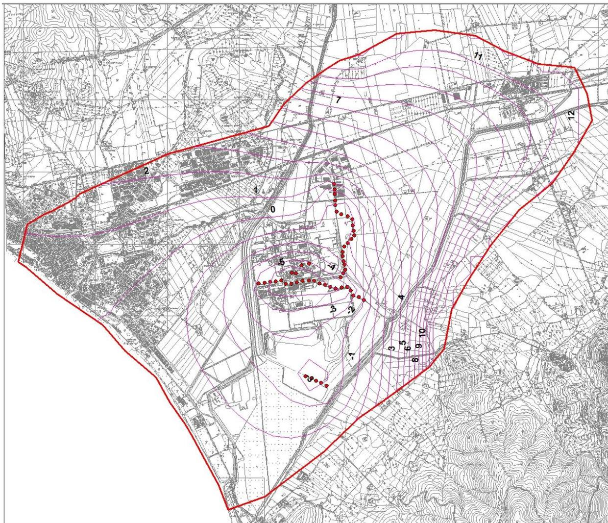
Figura 46. Carta delle isopiezometriche della falda superficiale nelle condizioni di progetto – stato transitorio (1° anno di progetto)
