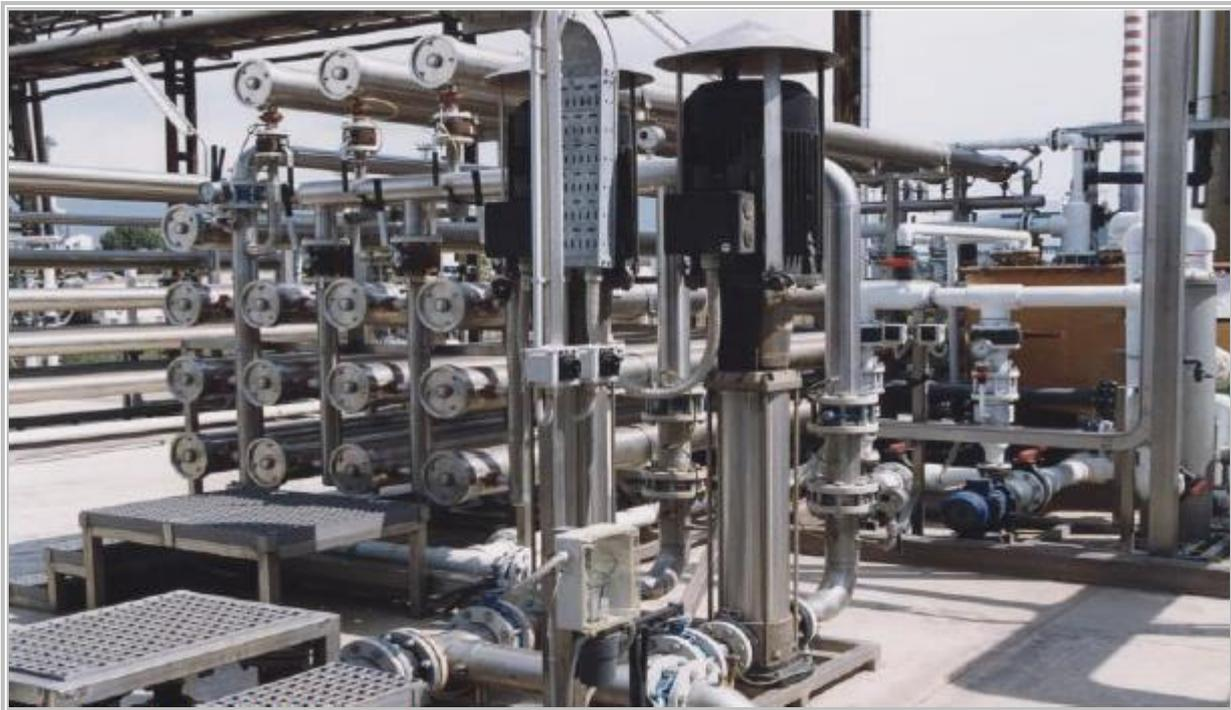
Figura 63. impianto di osmosi inversa Nuova Solmine
