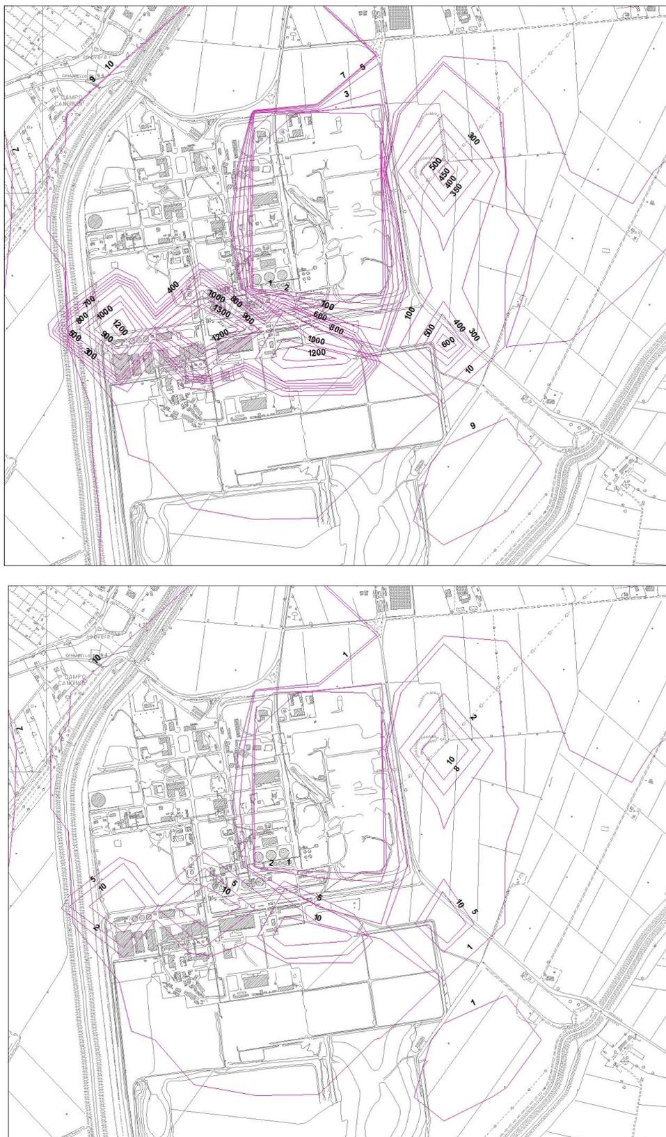
Figura 64. Carta delle isoconcentrazioni dell'arsenico della falda superficiale nelle condizioni di progetto– stato transitorio (in alto 38° anno di simulazione – 28° anno in condizioni di progetto, in basso 81° anno di simulazione – 71° anno in condizioni di progetto - unità di misura ug/l)
