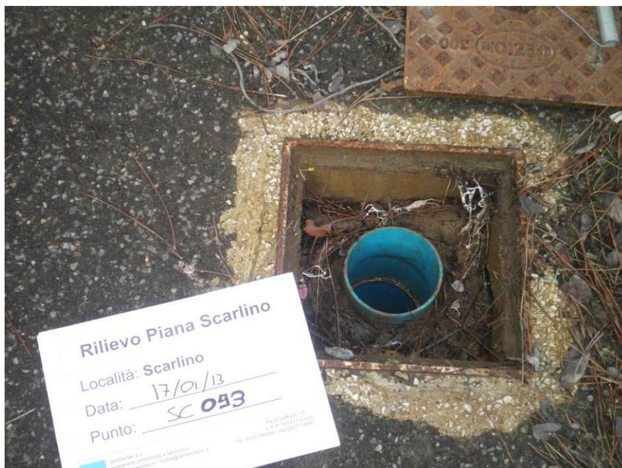
Figura 35: Esempio Rilievo fotografico con verifica della condizione del piezometro
